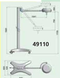
Cuscinetti a frizione regolabile montati su ogni snodo della lampada
